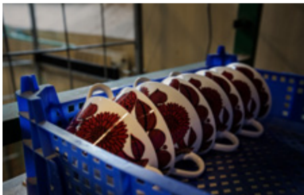
Koppar i serien Röd Aster som Stig Lindberg formgav 1972. Varje kopp bränns tre gånger vilket gör att den tål maskindisk och mikro.
